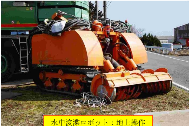
水中浚渫ロボット：地上操作 (電業社製)
